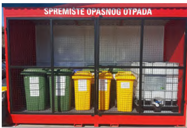
Slika 26 i 27. Primer skladišta za privremeno čuvanje opasnog otpada
